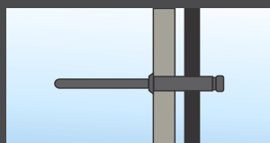
2 - Encaixe a peça até o rebite atravessar as camadas que serão fixadas.
